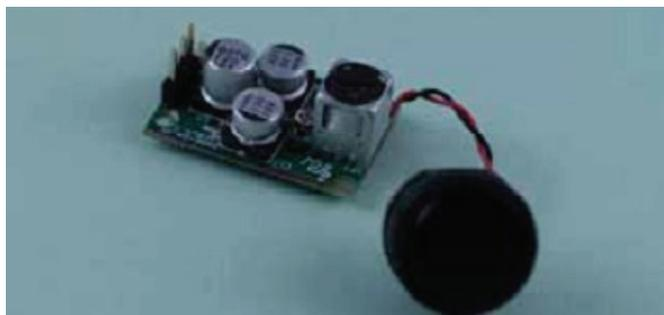
**Fig. 4** – *The SRM400 sensor.*
